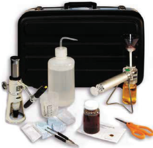
El Kit de Análisis de Fluidos Portátil de Donaldson incluye suficientes suministros para 100 muestras de fluido. Todos los artículos se encuentran empacados de manera segura y protegidos con acolchado de espuma grabado con láser en un robusto estuche de transporte.
